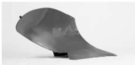
Sl. 4. Plužno telo br. 12. a) izgled plužnog tela, b) dužina daske, c) uporedni izgled tela 12, 15 i 20
