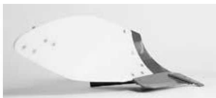
Sl. 5. Plužno telo KK br. 14. a) izgled plužnog tela, b) dužina daske, c) profil brazde
