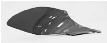
Sl. 3. Plužno telo KK br. 9. a) izgled plužnog tela, b) dužina daske
